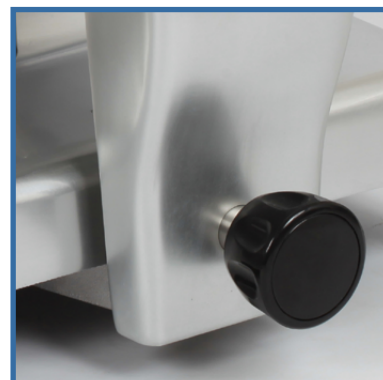
BLC - sistema blocco carro di scorrimento che consente di smontare il piatto e il suo supporto per avere così un comodo accesso nella parte sottostante per una più facile pulizia. BLC – block of sliding carriage which allows to disassemble the food tray and its bearing to obtain an easy access even in the lower part of the food tray for an easier cleaning.
